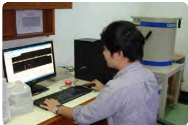
การใช้งานเครื่องวัดรังสีแกมมาชนิดเจอร์มานีเยม ความบริสุทธิ์สูง (HpGe)
